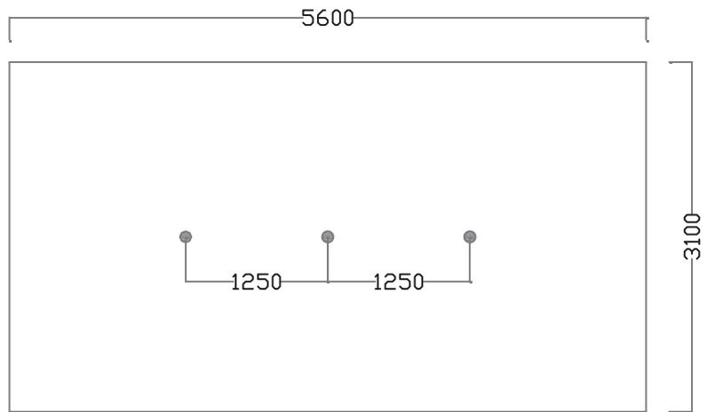
DIAMETRE RONDIN :  $\varnothing$  120 mm
